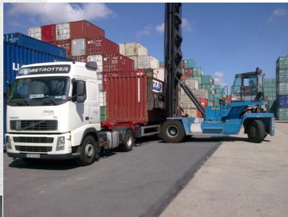
Après quelques secondes, la boîte est mise sur le châssis, plus qu'à verrouiller et c'est parti
