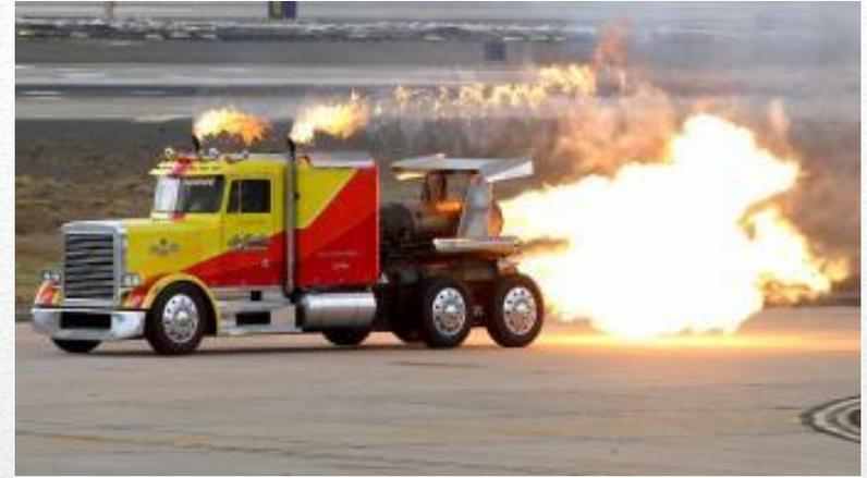
C'est un camion de course américain sur lequel on a posé 3 turbines d'avions de chasse. 18 tonnes de poussée 480 km/h 36000 chevaux et il crache le feu. Il accélère tellement vite que pour freiner il déploie un parachute
