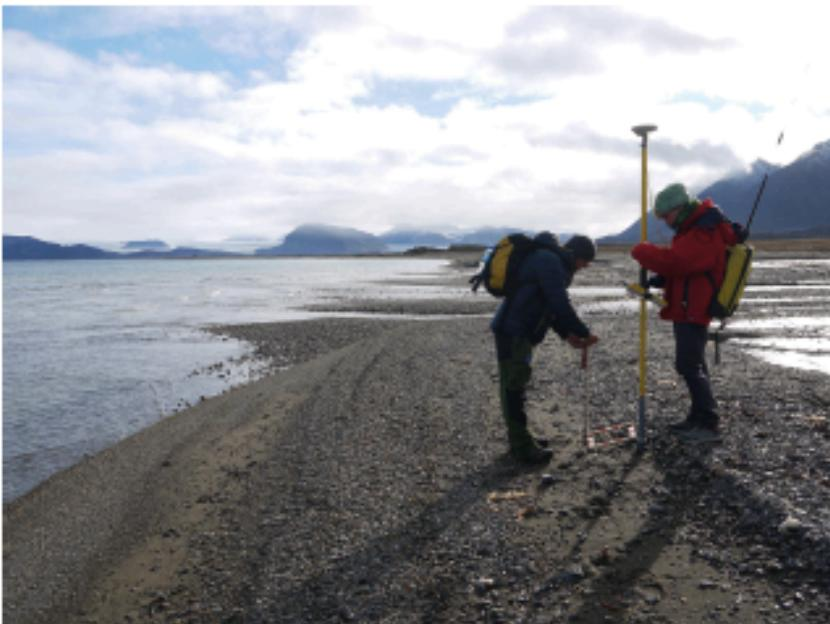
*Illustration 2 : Mesures de la position du trait de côte instantané et de la granulométrie des dépôts meubles sur la rive nord de la presqu'île de Brøgger (Cliché : D. Mercier, 15 août 2016).*
